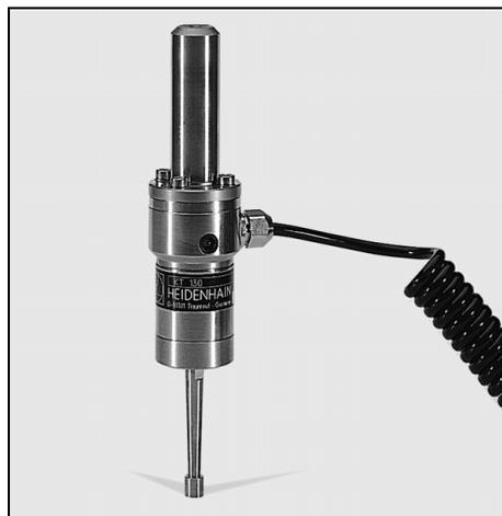
**Beispiel:** Werkstück-Kanten antasten und Eckpunkt als Bezugspunkt setzen.
